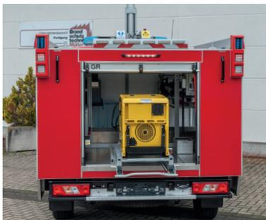
• TS-8 Lagerung mit Zwischenmodul zur Aufnahme vom Stromerzeuger 13 KVA herausziehbar.
