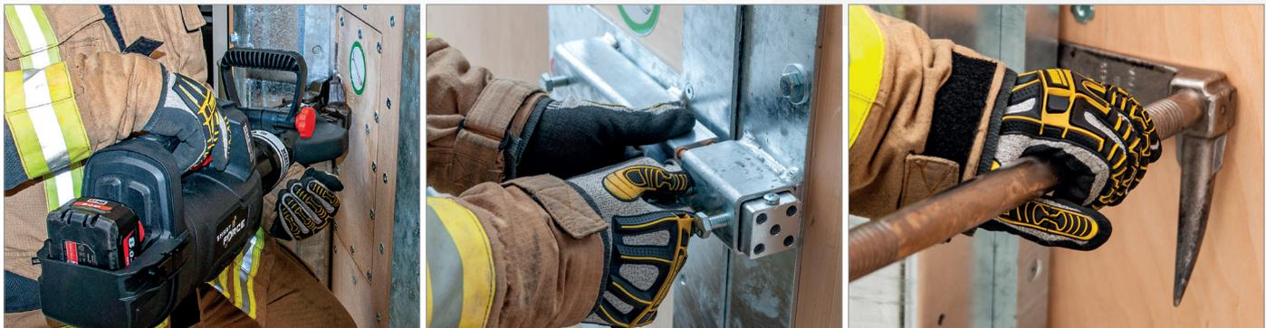
• Die Module der verschiedenen Öffnungsvarianten sind durch einfache Handgriffe schnell zu wechseln.
