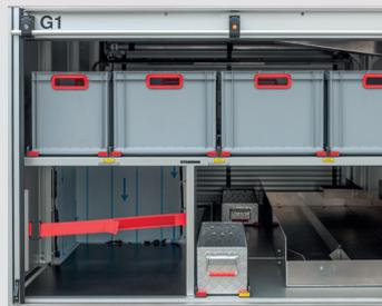
• Linke Aufbauseite G1, Rolläden mit Drehstangenverschluss abschließbar.
