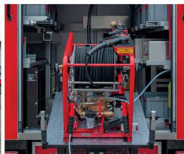
• Heckansicht **GR** mit Hochdrucklöschgerät **HLG WATERJET** auf **TS DIN** Lagerung.
