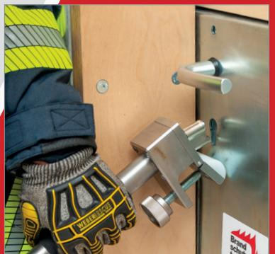
• Einhängen der Zugschraube in die Aussparung im *multiZETTEX*.
