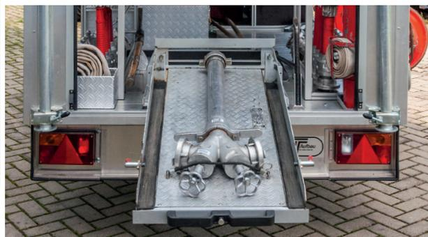
• Lagerungsschlitten TS mit Standrohrhalterung.
