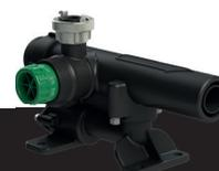
Die Schaumerzeuger und Venturi-Zumischer aus Verbundwerkstoff FiberTech® sind in Durchflussmengen von 200 oder 400 l/min erhältlich und besitzen dank FiberTech® ein sehr vorteilhaftes Gewicht. Sie bieten einen breiten Konzentrationsbereich von 0,1 bis 6 %, der für alle Arten von Schaummittel geeignet ist.
