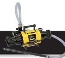
LEADER MIX 200-1000 Zumischer - automatisches und unabhängiges Schaum-Dosier-System. Der ideale Kompromiss zwischen klassischem Venturi-Zumischer und elektronischem Schaumdosiersystem: Der Leader MIX 200-1000 bietet eine präzise Dosierung aller Arten von Schaummitteln, selbst bei starken Schwankungen der Durchflussmenge. Ab bereits 5 bar ermöglicht er die präzise Dosierung des Schaummittels von 0,3-6 % bei einem Durchflussmengenbereich von 200 bis 1050 l/min.
