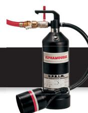
Der tragbare Zumischer UPRIM wurde speziell für die Brandbekämpfung entwickelt und verfügt dank seines Fassungsvermögens von 10 Litern Schaummitteln über die Löschkapazität von mehr als 40 Feuerlöschern. Er erweist sich als sehr einfach in der Verwendung: Das Schaummittel wird über die große Öffnung eingefüllt und das Gerät dann an eine Wasserversorgung (Wandhydrant usw.) angeschlossen.
