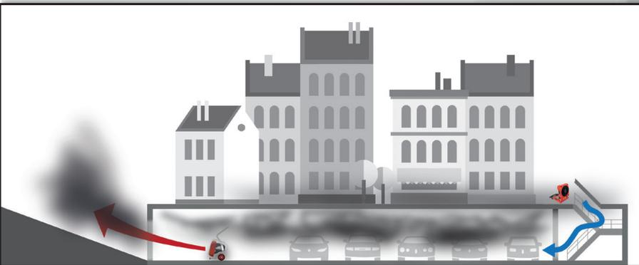
Im hier gezeigten Beispiel saugt der ParkFan 80 den Brandrauch aus dem Raum während der Angriffstrupp über das Treppenhaus in die Tiefgarage vorgeht. Um das Eindringen von Rauch in das Treppenhaus zu verhindern, sowie zusätzliche kühle Frischluft einzubringen, wird ein zusätzlicher Lüfter vor dem Treppenhaus platziert.
